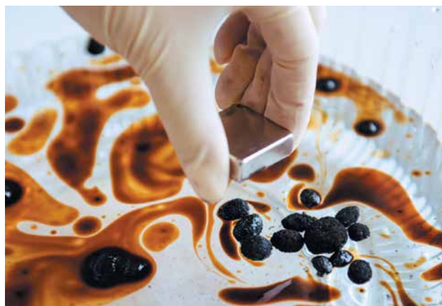
Еще одна уникальная находка ученых кузбасского политеха — магнитоуправляемые сорбенты для ликвидации разливов нефти и нефтепродуктов с водной поверхности при низких температурах.
