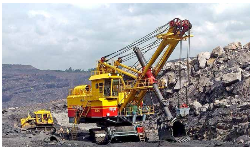
Фото 6. Экскаватор ЭКГ-10 на угольном разрезе Bharat Coking Coal Limited
